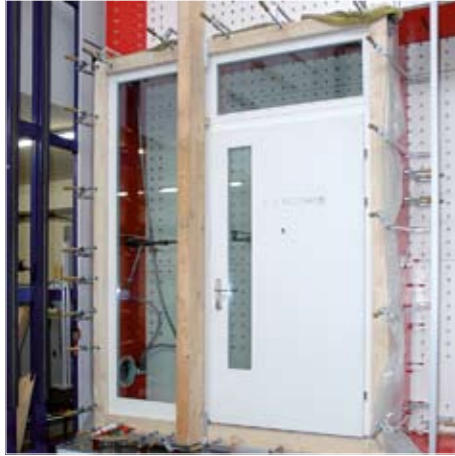
HUTER ISOPHON Klima-Laubgangtüre beim Klimaprüfverfahren nach ÖNORM EN 1121
