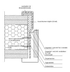
Die Firma Huter kann auch bestimmte Größen von T30-Nirozargen herstellen und einbauen. Auf Grund der enormen Verwindungskräfte bei hohen Temperaturen muss diese Zarge in geteilter Ausführung hergestellt werden.
