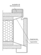
Wenn Zargen ohne Bodeneinstand montiert werden, ist an beiden Längsseiten ein zusätzlicher Bodenanker anzubringen.
