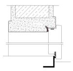
Die Zarge ins Mauerwerk stellen. Diese dann senkrecht, waagrecht, fluchtgerecht sowie höhenmäßig fixieren und dann voll ausbetonieren. Beim ausbetonieren ist darauf zu achten, dass die Hohlräume zwischen Mauerwerk und Zarge voll mit Mörtel hinterfüllt sind. Bei Betonwänden ist ein Betonvoranstrich notwendig.
